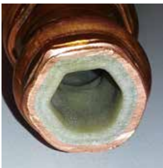
Kupferrohr mit Kalkschicht
