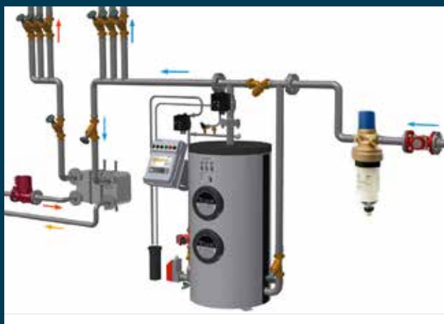
Schematische Darstellung einer Trinkwasser-Installation mit BIOCAT 14000
